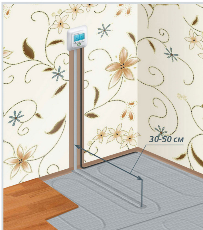
Схема укладки датчика температуры в гофрированной трубке
